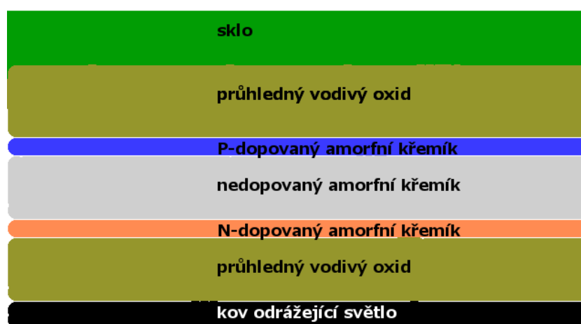
Obr. 11 Tenkovrstvý článek z amorfního křemíku, místo kovových kontaktů je použit průhledný vodivý oxid.
