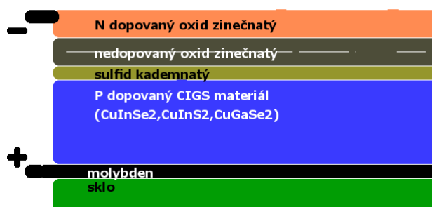
Obr. 32 CIGS článek, sklo slouží pouze jako podklad pro nanášení dalších vrstev.
