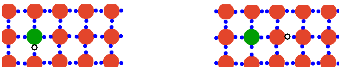
Obr. 1 Příklad difuze díry po krystalu křemíku (červeně) dopovaného bórem (zeleně). Elektrony modře a díra černě.
